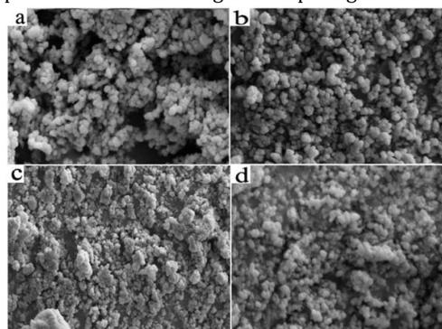
Fig. 2: SEM images of  $\text{Ag}_2\text{S}/\text{PbSO}_4$  nanocomposites (a) A1 (b) A2 (c) A3 (d) A4
