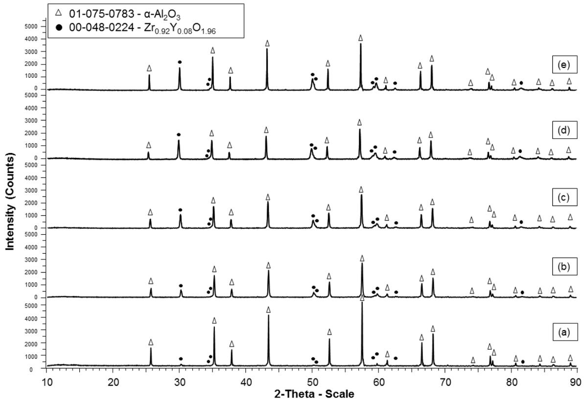
Fig. 2 XRD pattern of the  $\text{Al}_2\text{O}_3$  added 8YSZ (a) 5 wt.%, (b) 10 wt.%, (c) 15 wt.%, (d) 20 wt.% and (e) 25 wt.%
